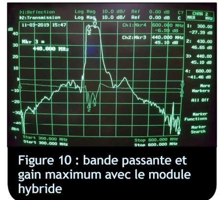
Figure 10 : bande passante et gain maximum avec le module hybride
