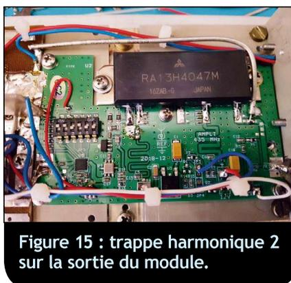
Figure 15 : trappe harmonique 2 sur la sortie du module.
