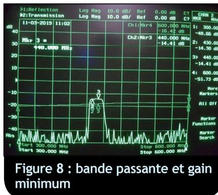
Figure 8 : bande passante et gain minimum
