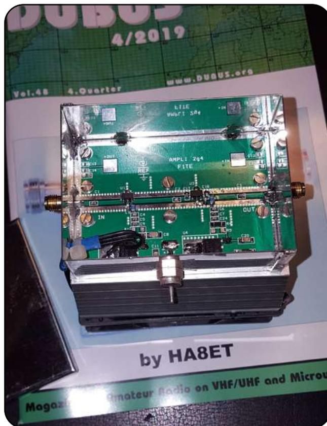
Le circuit imprimé mesure 52 X 72 mm, dimensions correspondant à une taille des boîtiers Schubert bien connus. Pour m'assurer de la reproductibilité du montage j'ai réalisé au moins quatre prototypes ayant tous donné des résultats similaires.
